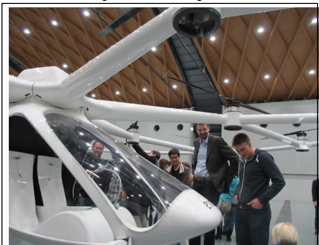
Abb. 3: e-Volocopter VC200 mit 18 elektrisch betriebenen Propellern und redundant verteilten GNSS-/MEMS/MOEMS Navigationssensoren und NAVKA Flight-Control
