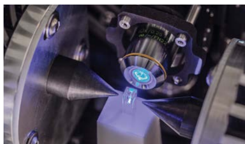
Erhöhtes Signal-zu-Rausch-Verhältnis durch Konzentrieren der magnetischen Beads in einem Laserspot mittels oszillierender Magnetfelder
