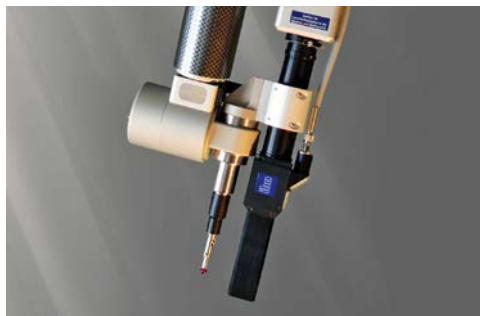
Vom ILM entwickelter 3-D-Scanner, montiert an einem Messarm
