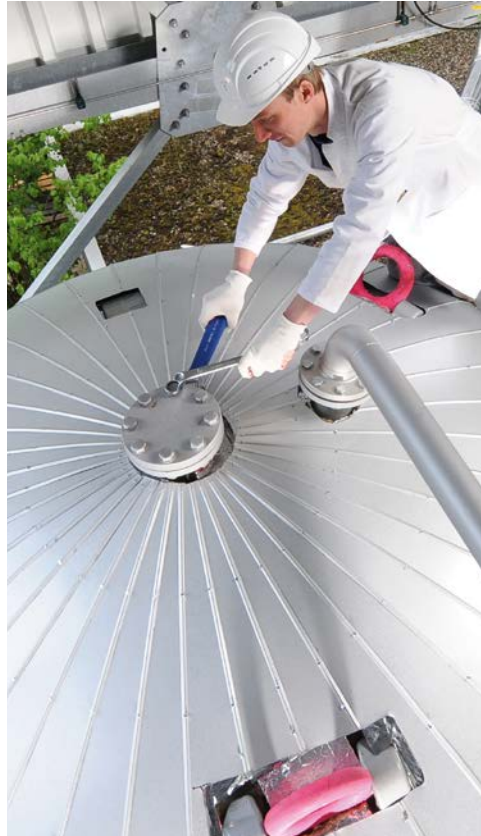
Anlage zur Untersuchung von Hochtemperaturwärmespeichern, die den Einsatz von erneuerbaren Energien vorantreiben und für höhere Wirkungsgrade in Industrieprozessen sorgen
