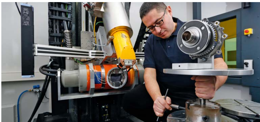
Vorbereitungen für den Test einer neuartigen Propellerbremse aus Hochleistungskeramik im Computertomografen
