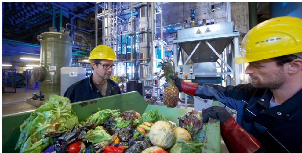
In dieser zweistufigen Demonstrationsanlage entsteht aus Obst- und Gemüseabfällen vom Großmarkt Biogas. Damit lassen sich, als Kraftstoff aufbereitet, Erdgasautos betanken.
