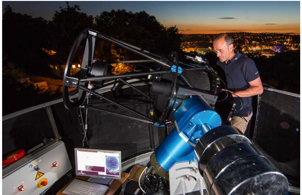
Mit Hilfe eines laserbasierten Verfahrens wollen DLR-Forscher in Zukunft die Flugbahn von Weltraumschrott möglichst genau bestimmen.
