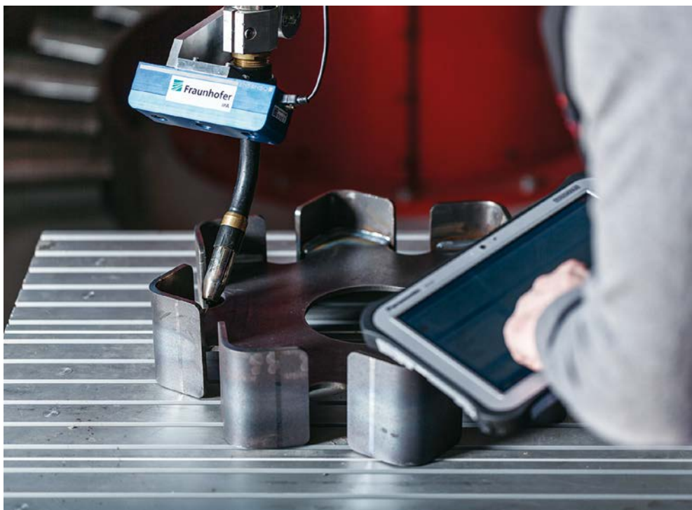
Schweißroboterassistent »CoWeldRob« garantiert eine konstant hohe Qualität der Schweißergebnisse durch die automatische Programmgenerierung und Prozesskontrolle.
