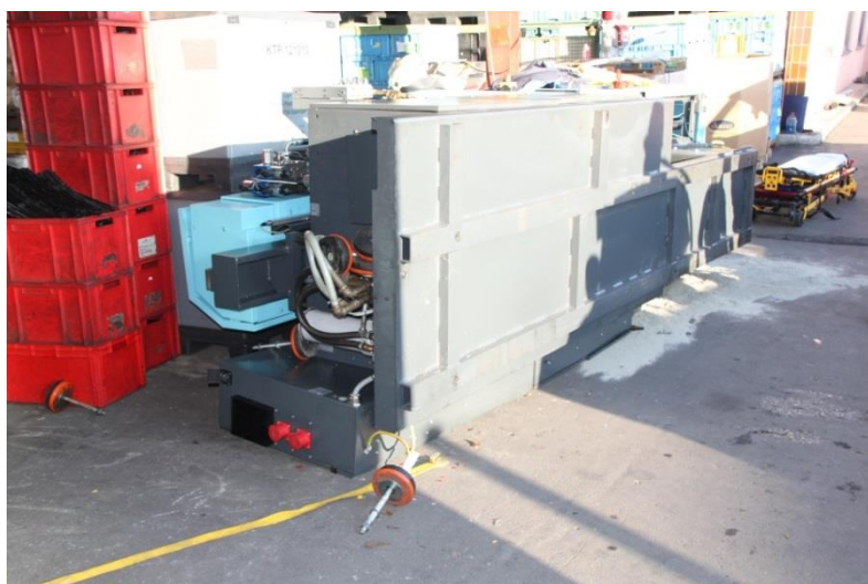
Bild: Umgestürzte Spritzgießmaschine
