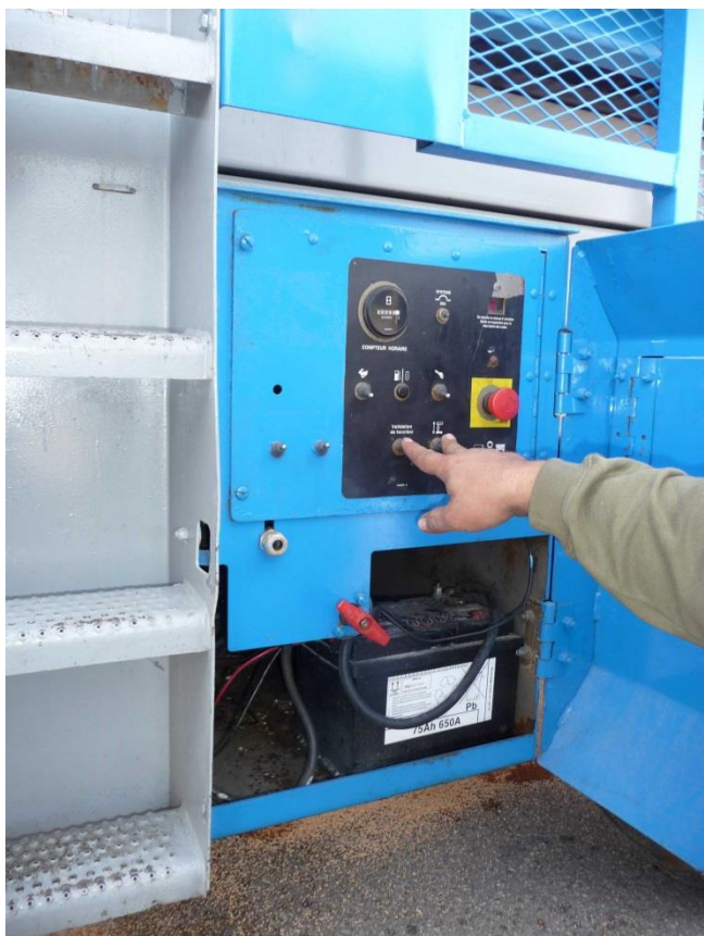
Bild: Notablassfunktion der Scherenhubarbeitsbühne
