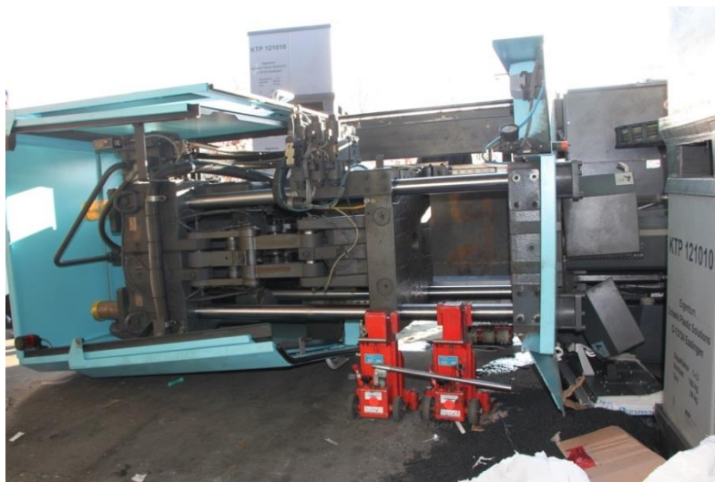
Bild: Umgestürzte Spritzgießmaschine mit hydraulischen Hebehilfen
