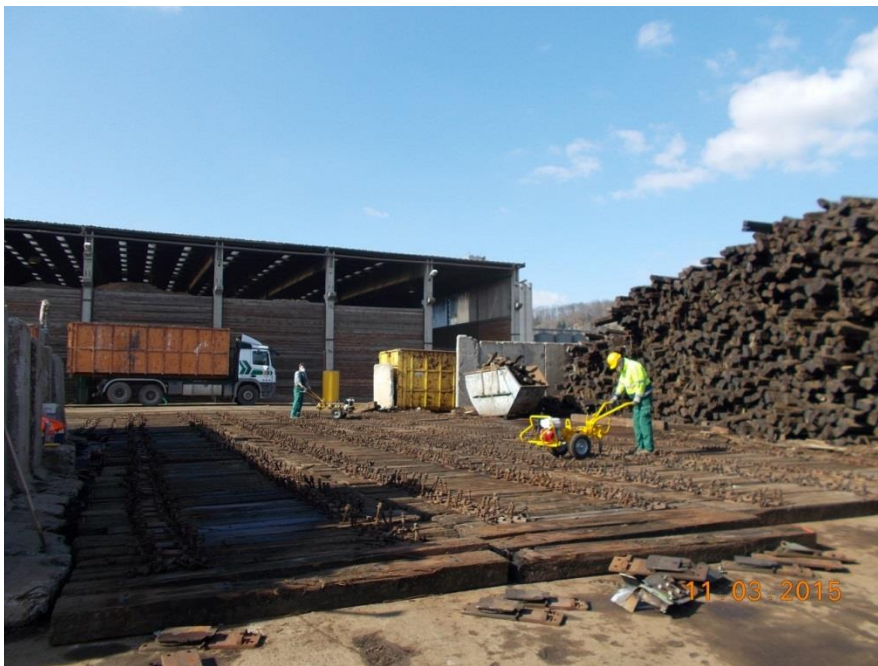
Bild: Abplatten von Bahnschwellen auf dem Recyclinghof
