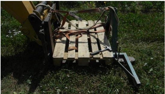
Bild 2: Die unzulässige Arbeitsplattform im Detail
