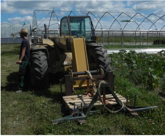
Bild 1: Der Teleskopstapler mit der selbst gebauten Hebevorrichtung
