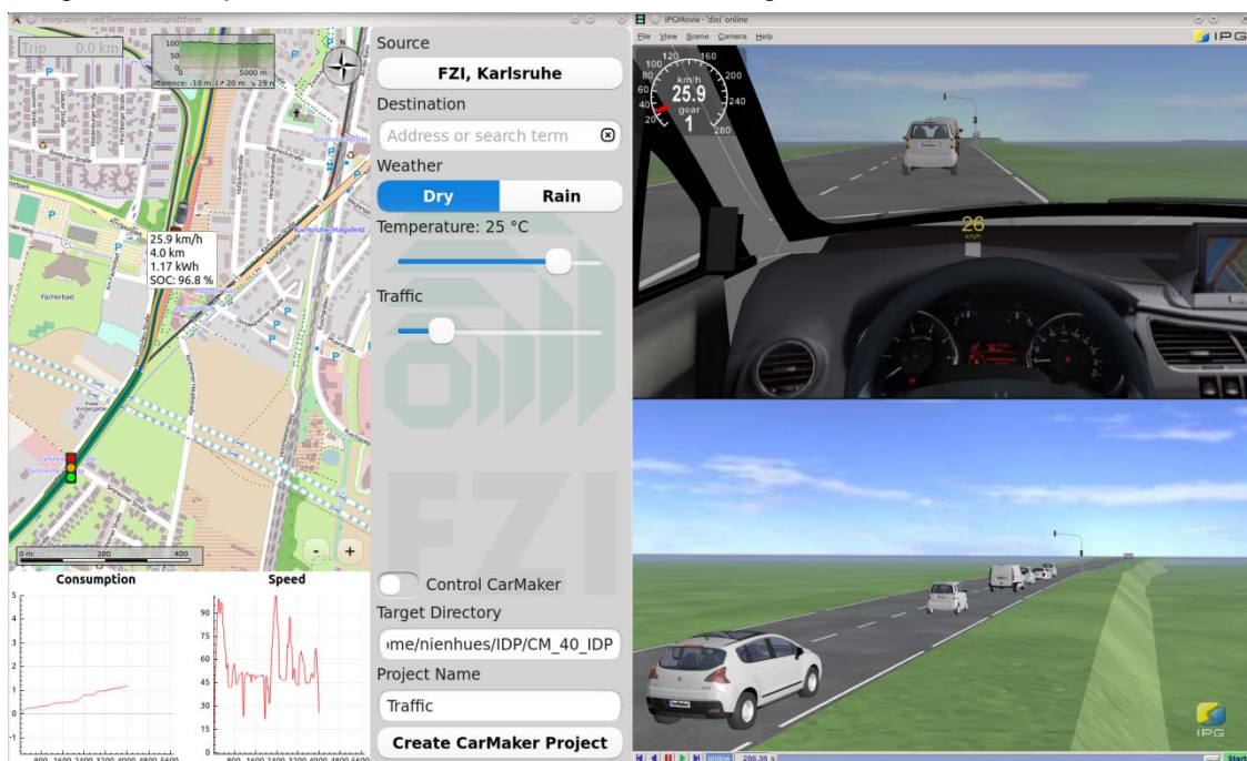
Streckenkonfiguration und Anzeige wichtiger Simulationsdaten (links) sowie Fahrsimulation mit Echtzeitverkehr in IPG CarMaker (rechts).
