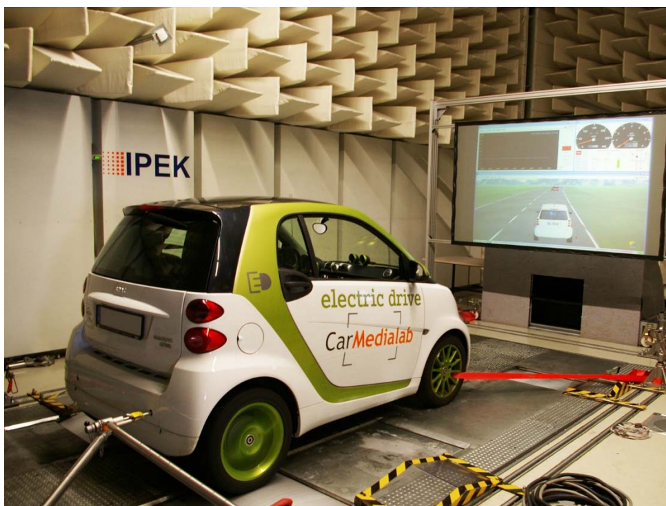
IDP Validierungsplattform am Beispiel eines realen Fahrzeugs im Verbund mit der Simulationsumgebung
