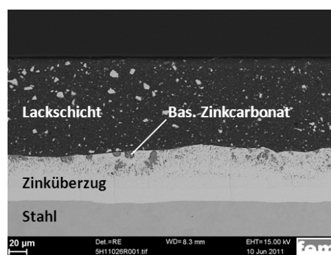
Abb. 2: Rasterelektronenmikroskopische Aufnahme: Querschliff durch duplexbeschichtete Probe aus niedrigsiliziumstahl (0,01% Si), Ionenstrahlgeätzt
