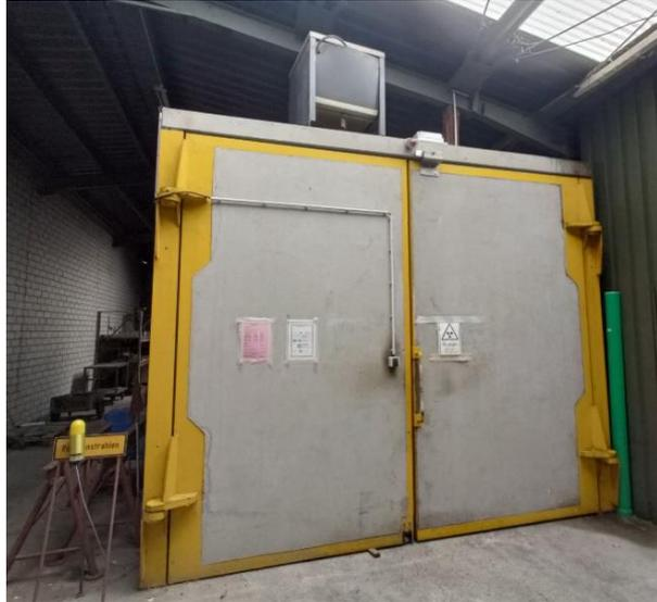
Abbildung 1: Strahlenschutz bunker
