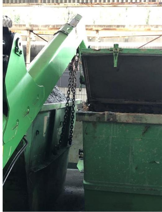
*Abb. 2: Sicherung der Befestigungspunkte (zum Unfallzeitpunkt nur vorne)*
