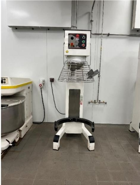
*Bild 1: Varimixer Teigrührmaschine ordnungsgemäßer Betriebszustand*
