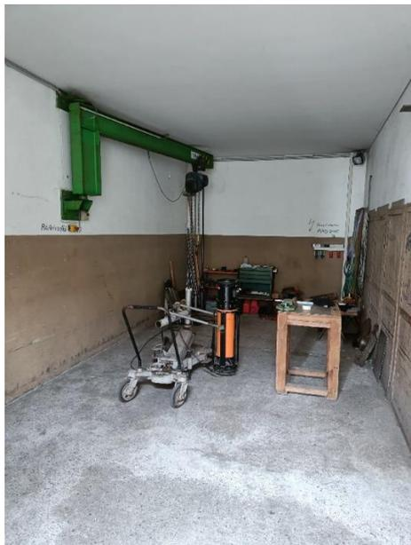
Abbildung 2: Röntgeneinrichtung zur Schweißnahtprüfung im Strahlenschutz bunker
