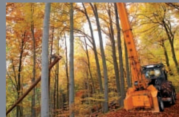
*Ein Kurzstreckenseilkran im Einsatz: Durch den schwebenden Transport werden Schleifspuren bzw. Schäden im Boden vermieden.*
