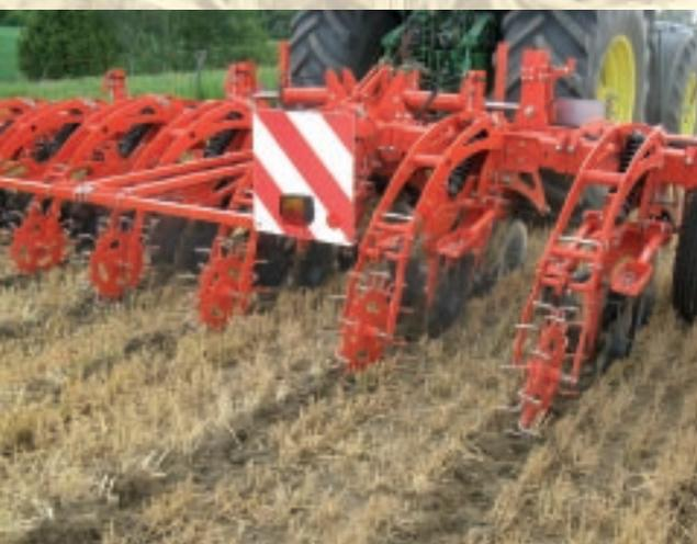
Maschine zur Streifenbodenbearbeitung.
