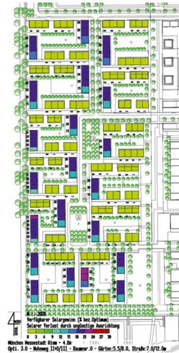
Abb. 3/18 Solarer Verlust durch ungünstige Gebäudeausrichtung, GORETZKI, 2012
