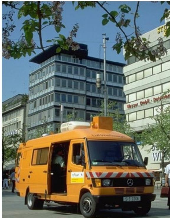
Abb. 4/3 Mobile Messeinrichtung für Luftschadstoffe und meteorologische Größen
