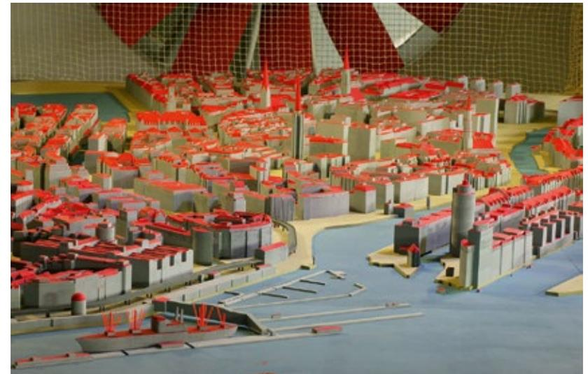
Abb. 4/9a Modell im Windkanal, Quelle: UNIVERSITÄT HAMBURG, INSTITUT FÜR METEOROLOGIE
