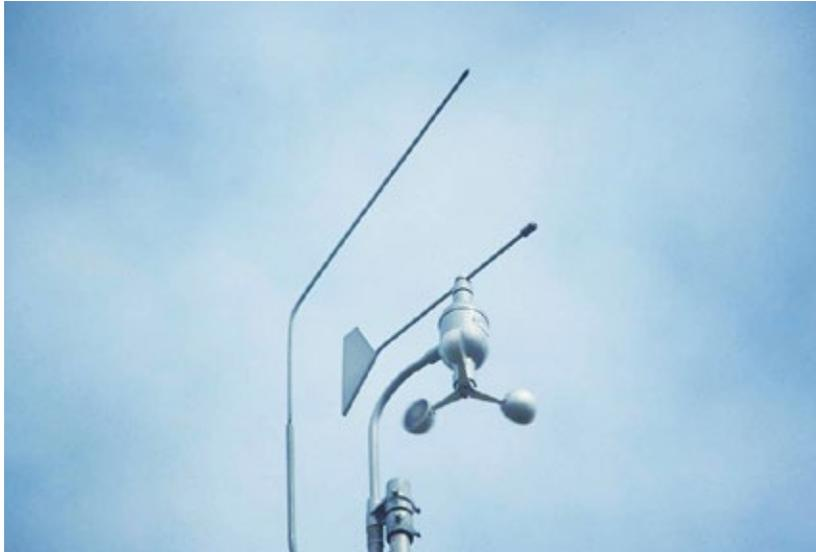
Abb. 3/25 Windmesser (Schalenstern-Anemometer)
