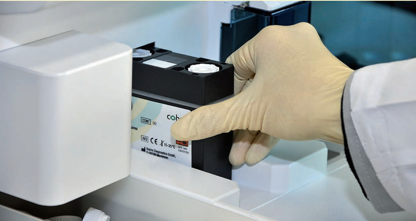
Typische Reagenzkartusche heutiger In-vitro-Diagnostik-Laborsysteme.
