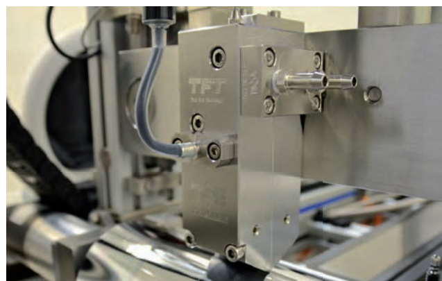
Schlitzdüsenbeschichtung an der Hochpräzisions-schlitzzußanlage
